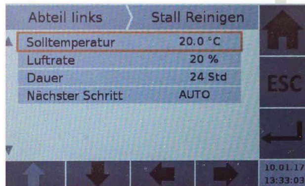
Interessante Details: Unter dem Menüpunkt „Stall Reinigen“ kann die Luftrate, die Dauer der Reinigung und der Zeitpunkt zum Aufheizen vorgegeben werden.
